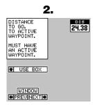
THE BOX SELECTION SCREEN APPEARS. PRESS THE RIGHT ARROW KEY UNTIL THE DESIRED BOX APPEARS.
